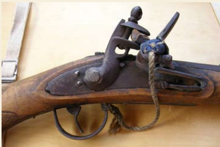
Boven Een musket met vuursteen. In het wapen zit een mechanisme dat er voor zorgt dat het vuursteen op een stuk staal slaat als je trekker over haalt. Hier komen vonken vanaf die het buskruit aansteken.
