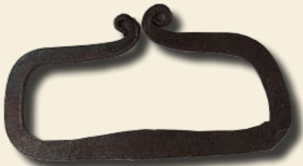
Stalen vuurslag. Aan de krullen houd je de vuurslag vast, met de andere kant kets je tegen een stuk vuursteen.
